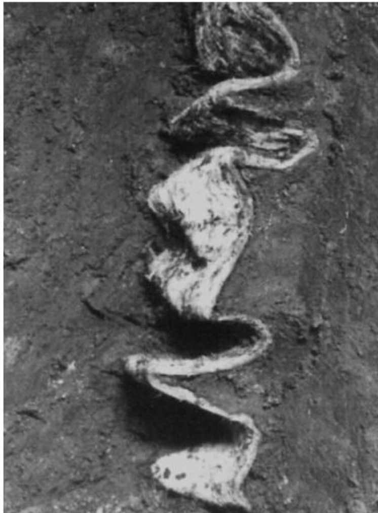
شکل الف ۴ - انباشتگی و پیچ خوردگی زهکش به علت فشردگی نسبی زیاد برگ
