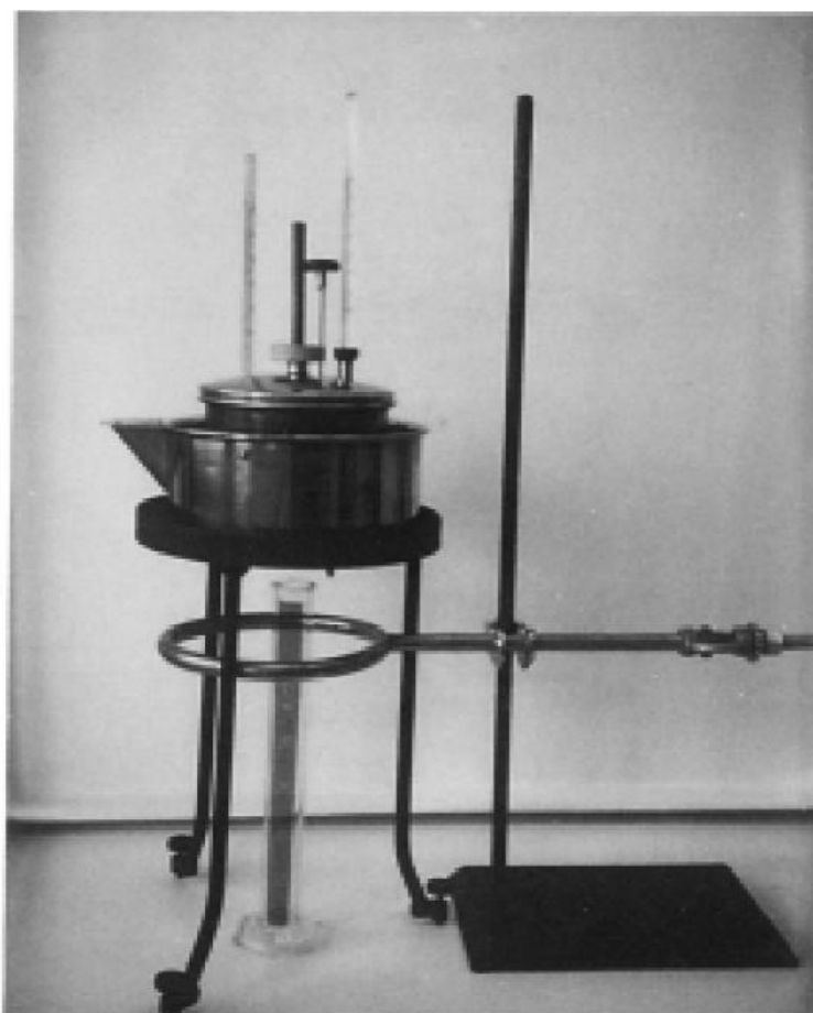
شکل ۲- گرانروی‌سنج انگلر در حال استفاده از استوانه مدرج ۵۰ ml
