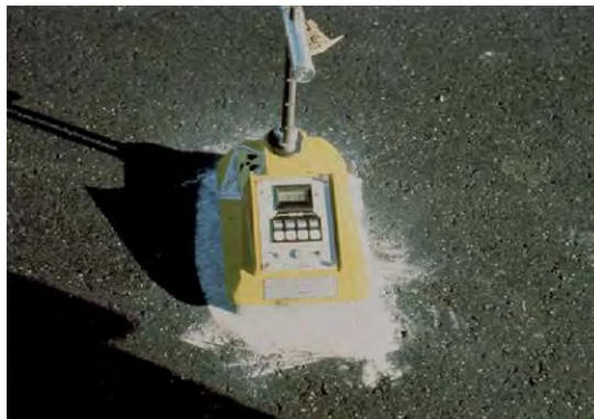
شکل ۳۸- دستگاه تعیین دانسیته به روش هسته‌ای
