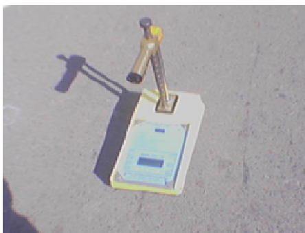
شکل ۴۷- دانسیته‌سنج هسته‌ای هنگام کالیبراسیون
