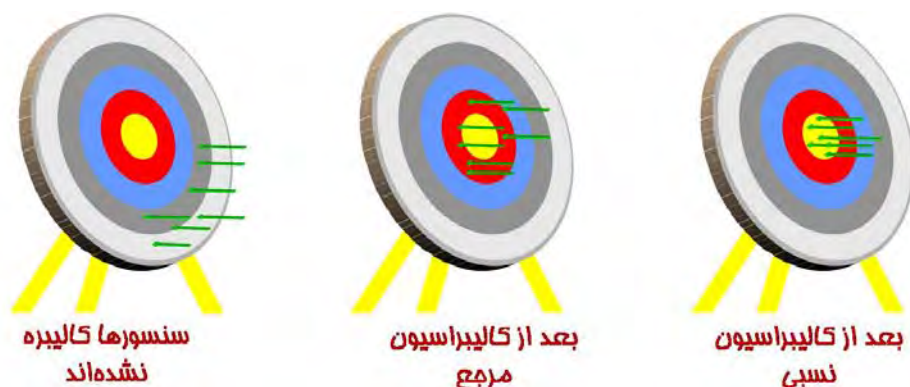
شکل ۲۱- تصویر شماتیک از دقت کالیبراسیون‌ها
