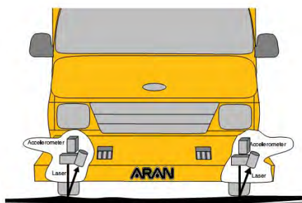
شکل ۷۹- سامانه لیرزی در قسمت جلوی دستگاه برای تعیین پروفیل طولی راه
