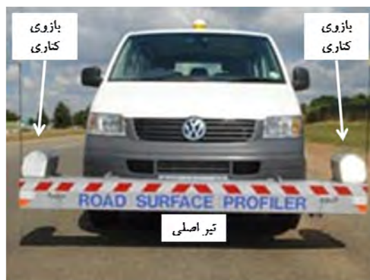
شکل ۷۲- ساختار دستگاه RSP
