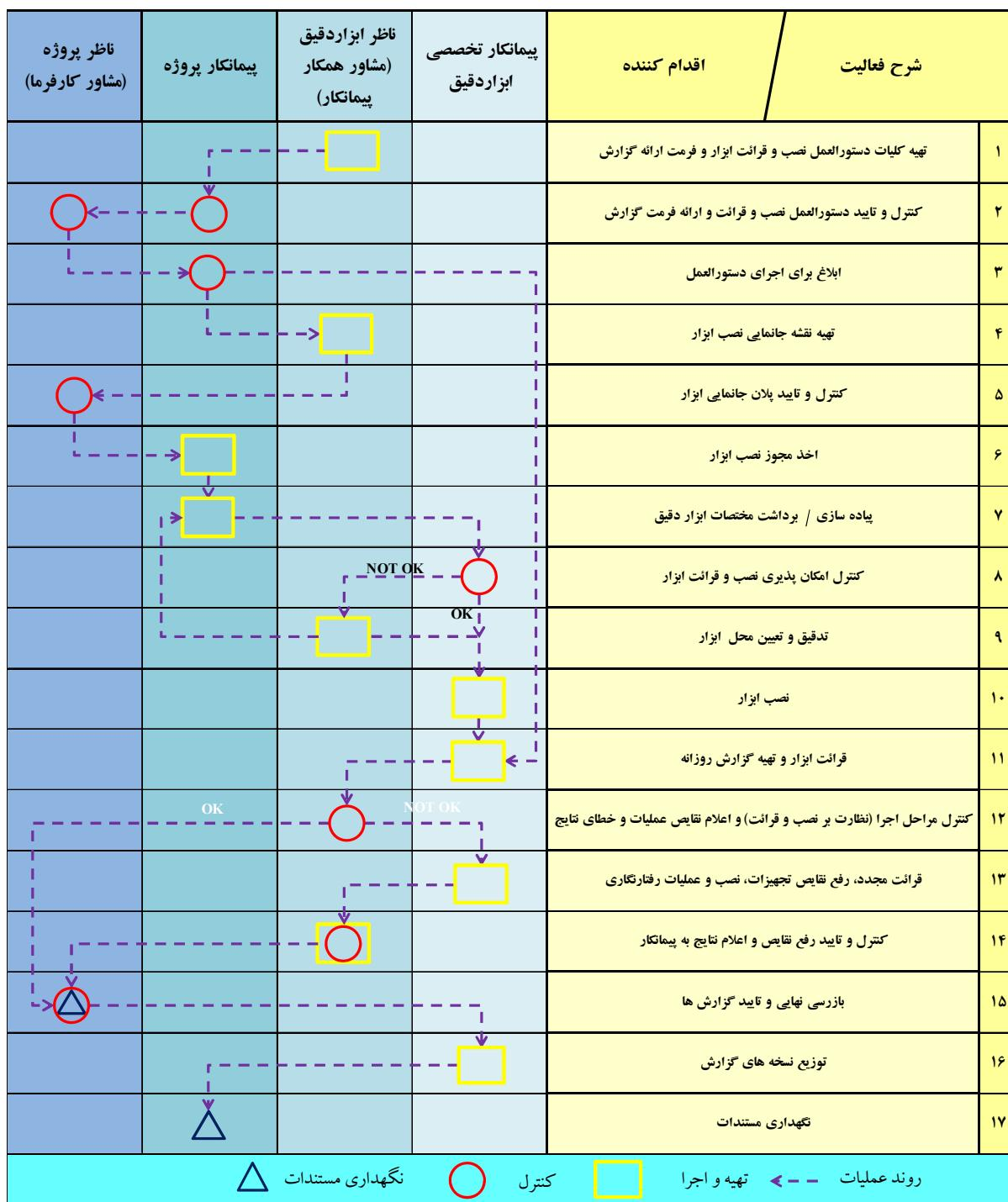
شکل ۲-۲- نمودار روند انجام عملیات ابزاربندی و رفتارنگاری حین اجرای تونل
