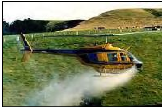
شکل ۲-۸- سیستم‌های اسپری ثابت برای هلی کوپترها (REMPEC, 2011)
