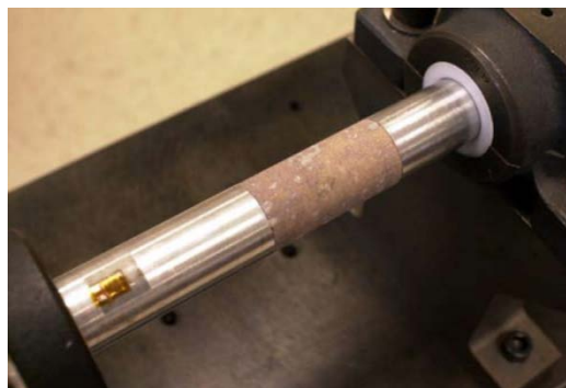
شکل ۹-۲- نحوه قرار گرفتن نمونه کانسنگ در دستگاه آزمایش میلۀ فشار هاپکینسون
