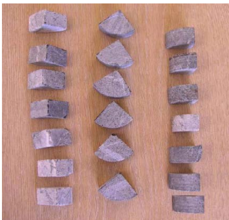
شکل ۱۳-۱- جهت‌گیری‌های مختلف ذرات نمونه برای آزمایش سقوط وزنه
