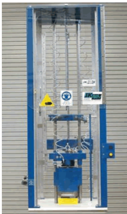
شکل ۱۰-۱- دستگاه سقوط وزنه JK مورد استفاده در آزمایش تعیین شاخص t_{10}
