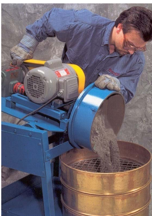
شکل ۱-۶- آسیای آزمایشگاهی مورد استفاده در تعیین شاخص توان نیمه‌خودشکن
