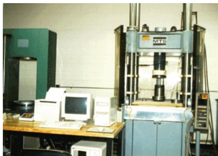
شکل ۸-۱- دستگاه اندازه‌گیری مقاومت فشاری تک محوری سنگ
