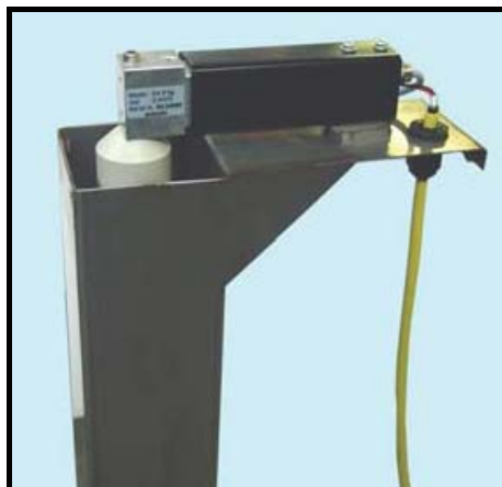
شکل پ. ۵-۴۹- دستگاه اندازه‌گیری خودکار تراز آب در سرریز مثلثی برای محاسبه دبی تراوش
