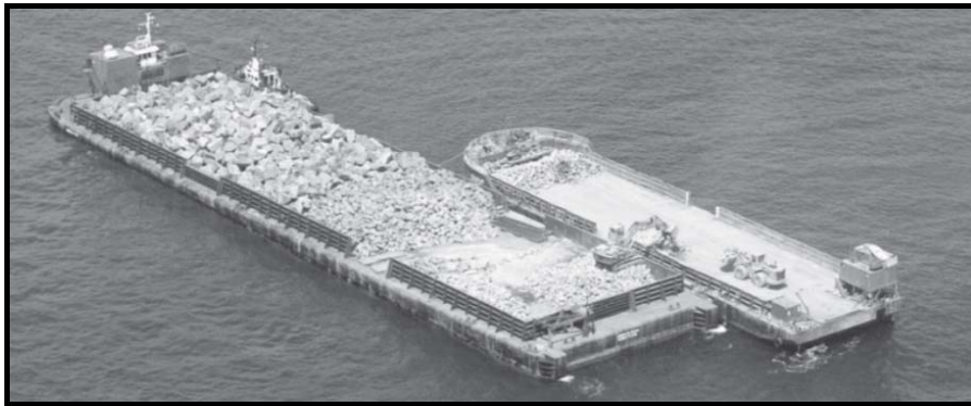
شکل ۵-۹- نمونه‌ای از یک بارج تخت که ۲۰۰۰۰ تن مصالح سنگی را حمل می‌کند
