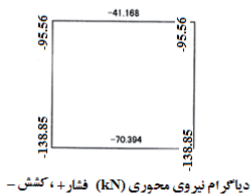
شکل ۱۰-۲۹- دیاگرام تنش در حالت سکون (بار چرخ در نظر گرفته شده است. شناوری در نظر گرفته نشده است.)
