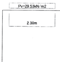
شکل ۱۰-۲۴- بار زنده (فشار لرزه‌ای قائم)
