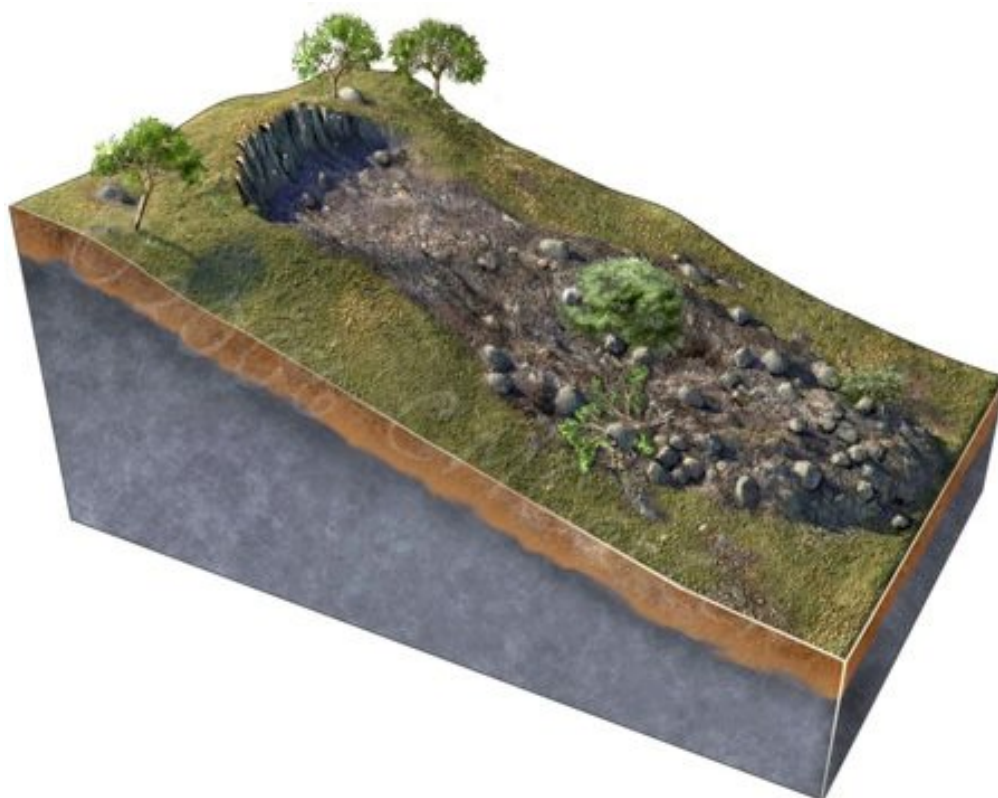
شکل ۵-۱۵- نمای شماتیک از وقوع زمین لغزه در یک شیب تند
