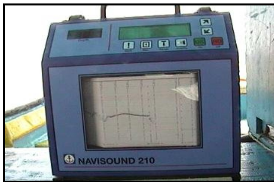
شکل ۳-۴- عمق‌سنج مدل NAVISOUND210
