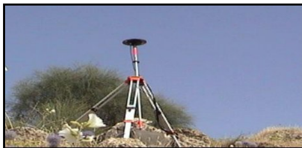
شکل ۳-۵- آنتن GPS معرف نصب شده بر روی نقطه با مختصات معین
