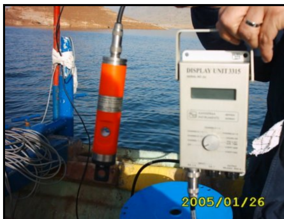
شکل ۳-۷- قسمت‌های مختلف دستگاه سرعت سنج صوتی (CTD)
