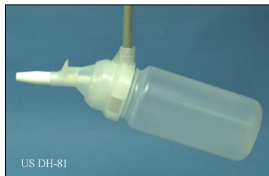
شکل پ. ۱-۱۱ - نمونه‌بردار بار معلق DH-81
