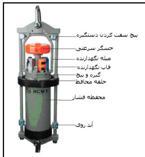
شکل پ. ۱-۳۸- دستگاه جریان‌سنج نقطه‌ای RCM 9 [۱۷]
