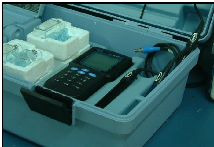
شکل پ. ۱-۴۵- دستگاه Sension جهت اندازه‌گیری متغیرهای کیفی آب [۱۷]
