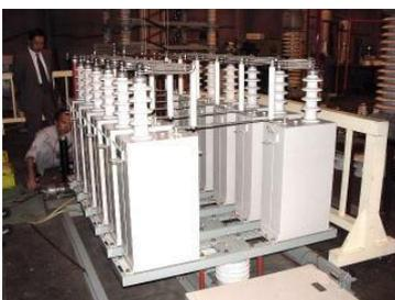
خازن به منظور جبران توان سلفی تمام تاسیسات یا فقط قسمتی از تاسیسات به کار برده می‌شود.
